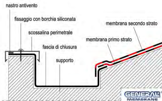
Fig. 30- Canali di grondaia
